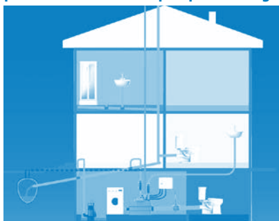
Figura 1: Esempio di installazione con pompa sommergibile:
